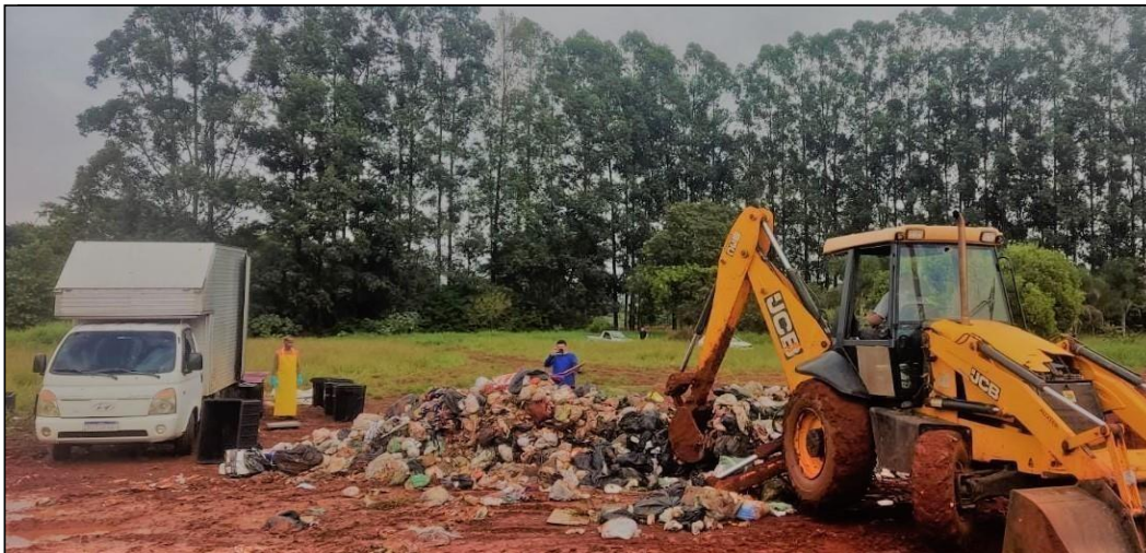
Figura 20. Campanha operacional de campo para a realização dos estudos gravimétricos de RSU no aterro municipal (Campina do Monte Alegre).
