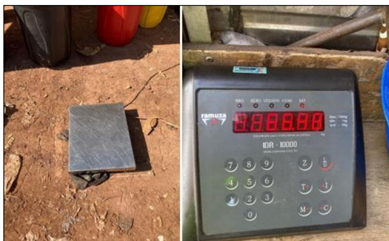
Figura 24 - Balanças para aferição da massa conforme a separação dos tipos dos resíduos sólidos urbanos.
